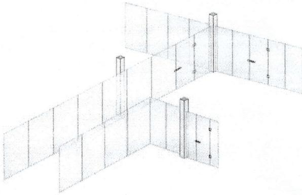
Având în vedere că construcția nu este fixată de tavan, pentru stabilizarea ei în partea de sus trebuie utilizată o țeavă din oțel inoxidabil de 60\*30. Altfel, peretii despărțitori vor fi instabili.
