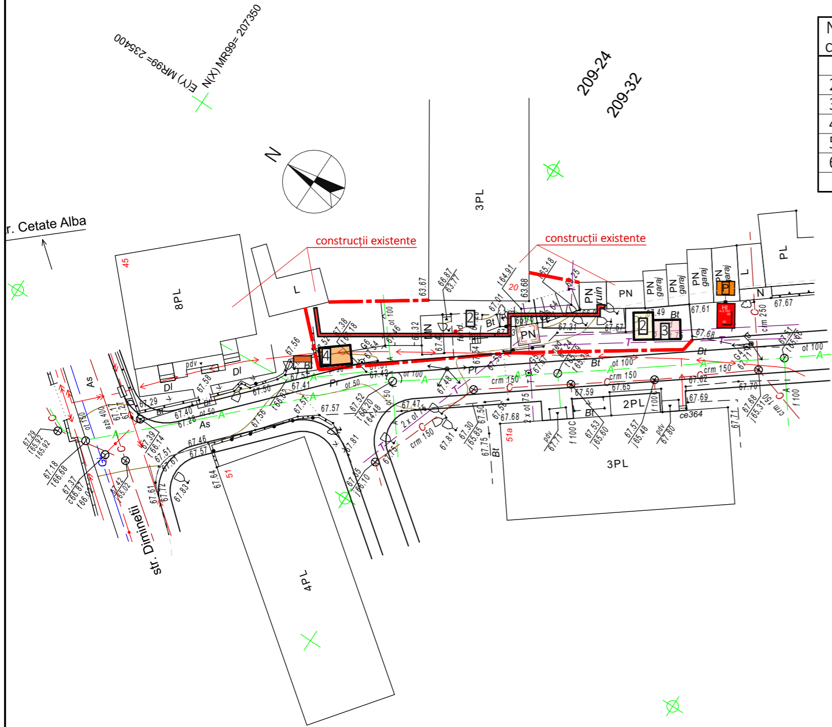
SCHEMA ÎNGRĂDIRII TEMPORARE A TERENULUI DE CONSTRUCTIE CU PANOURI DIN TABLA ZINCATA
