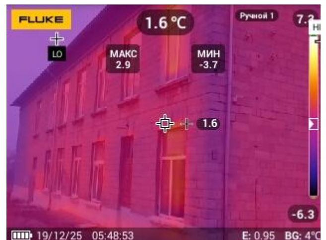
Figura 12. Termograma pereților Bloc Central
