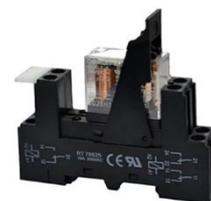
В виду необходимости усиления характеристик контактной группы ППУ для отключения кухонного оборудования (плиты, фритюрницы и т.п.) и общеобменной вентиляции пищевого блока, рекомендуется применить реле с напряжением питания АС/DC 24V с двумя группами переключающихся контактов с проходящим током до 10А с низким потреблением тока катушкой. Установить непосредственно в электрическом шкафу на Din-рейку. Подключение контактов реле к отключающим устройствам выполняется силами Заказчика самостоятельно.
