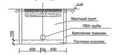
Схема укладки напорного трубопровода из PE в траншее
