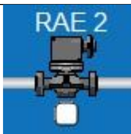
Fig.1 Exemplu de robinet cu acționare electrică în poziția ÎNCHIS și cheia de comandă în poziția 0
