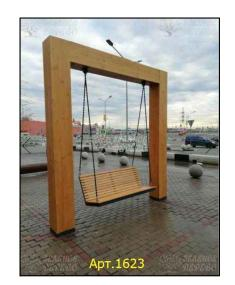
Стойки 200\*200мм. -клееный брус Стойки на металлическом основании с заглублением на 1,5-1,8м. Пергола на качели размеры 2800\*3000мм. Диван качели 1700мм. в длину Вес балки- 137,6кг
