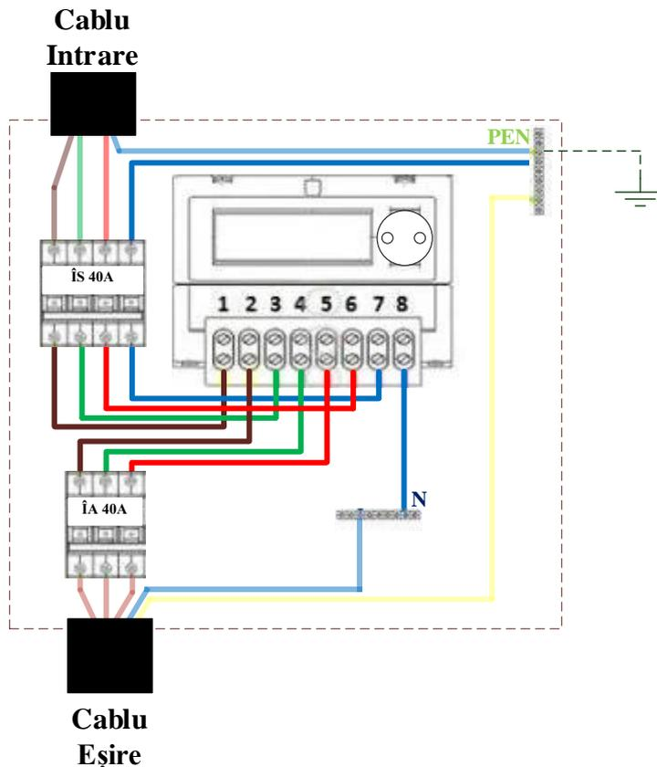
Produsul permite racordarea cu un cablu de bransament aerian, de aluminiu cu secțiunea de la 16 - 25 mm<sup>2</sup>.
