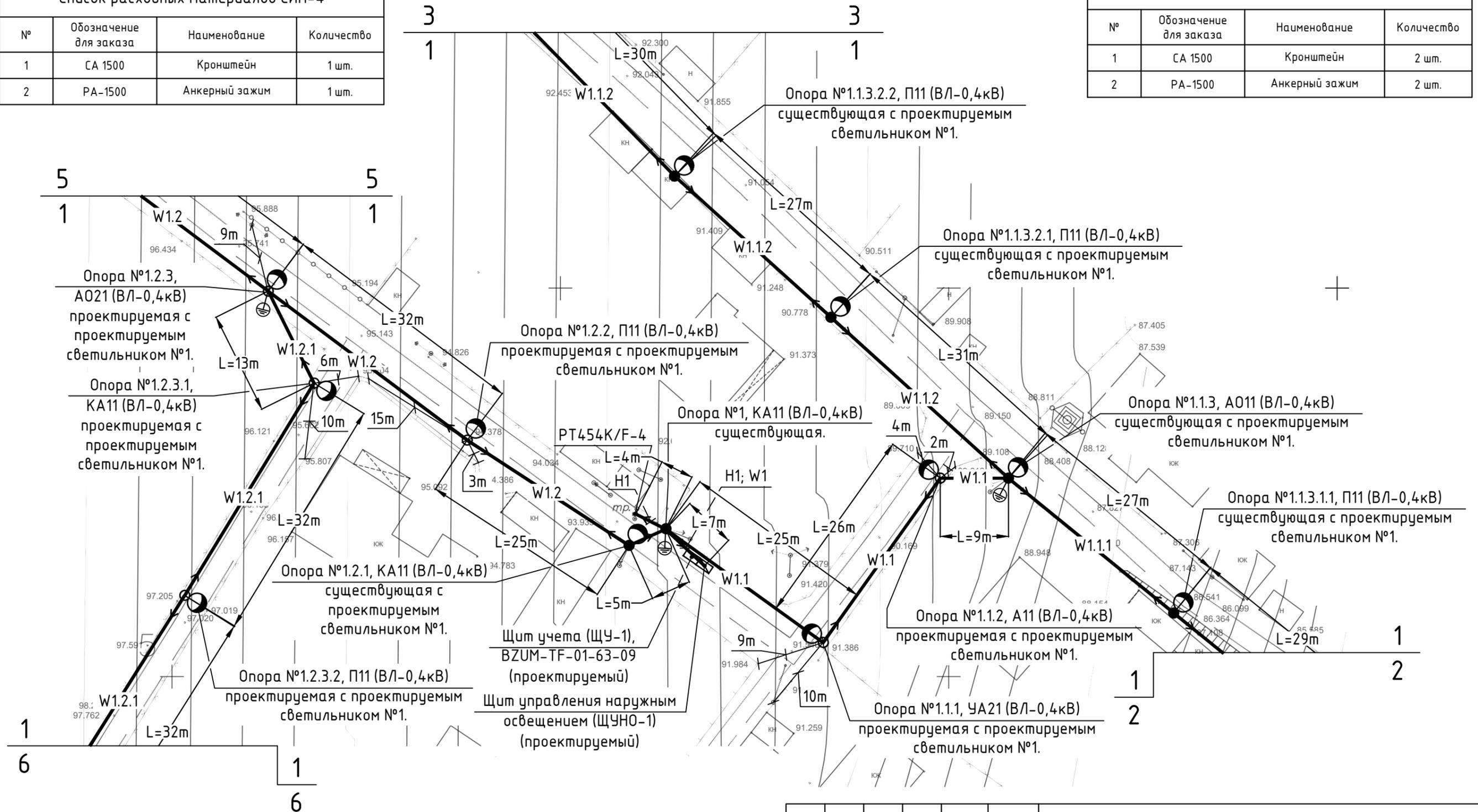
Ведомость существующих опор ВЛ-0,4кВ (опоры на базе стойки СВ-105)
