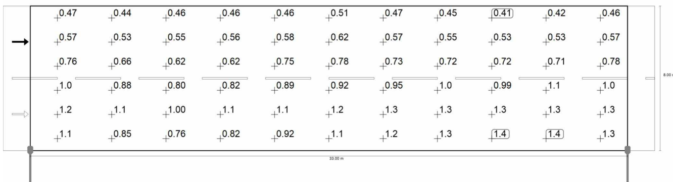
Observator 2: Densitatea luminii la instalația nouă [cd/m 2 ] (Raster valoric)
