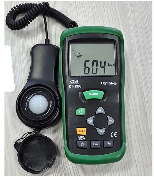
Figura 5. Rezultatele măsurării iluminării cu un luxmetru
