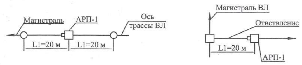
Схемы установки 3 x однополюсных аппарата предохранитель-разъединитель на анкерной опоре А10-1
