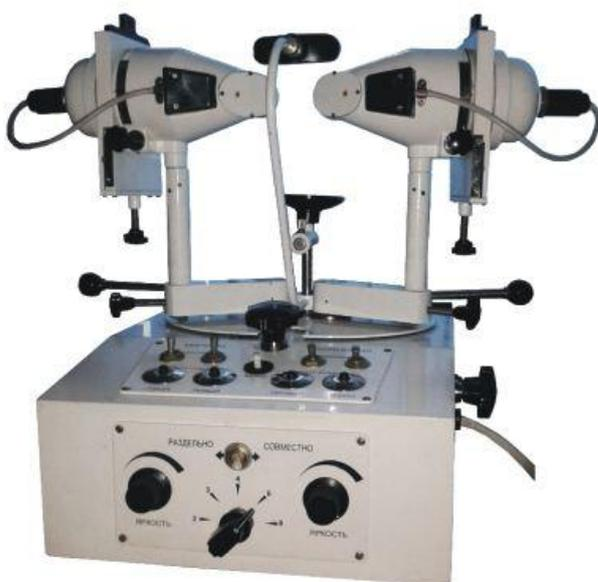
**Синоптофор СИФ-1** предназначен для диагностики и лечения косоглазия и используется для определения объективного и субъективного углов косоглазия, состояния корреспонденции сетчаток, способности к бинокулярному слиянию, фузионных резервов, наличия или отсутствия функциональной скотомы, наличия нефовеального слияния.
