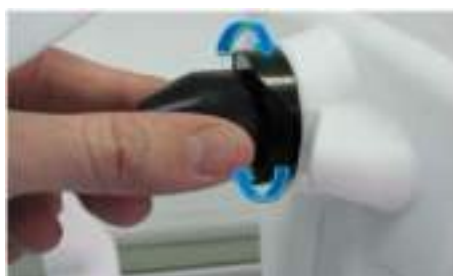
Figura 68. Rotirea adaptorului pentru camera anterioară
