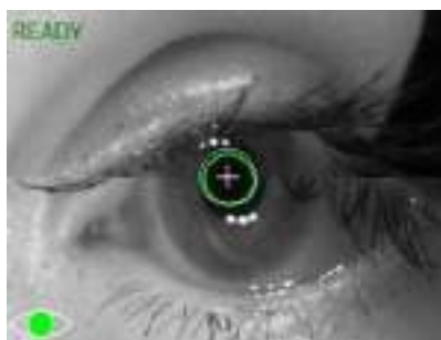
Figura 33. Poziția capului de măsurare corect aliniat
