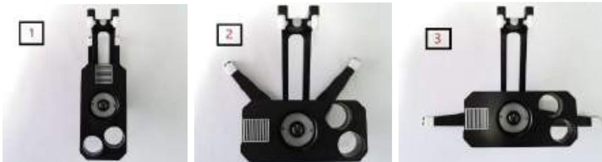
Figura 438. Deschiderea instrumentului de calibrare REVO
