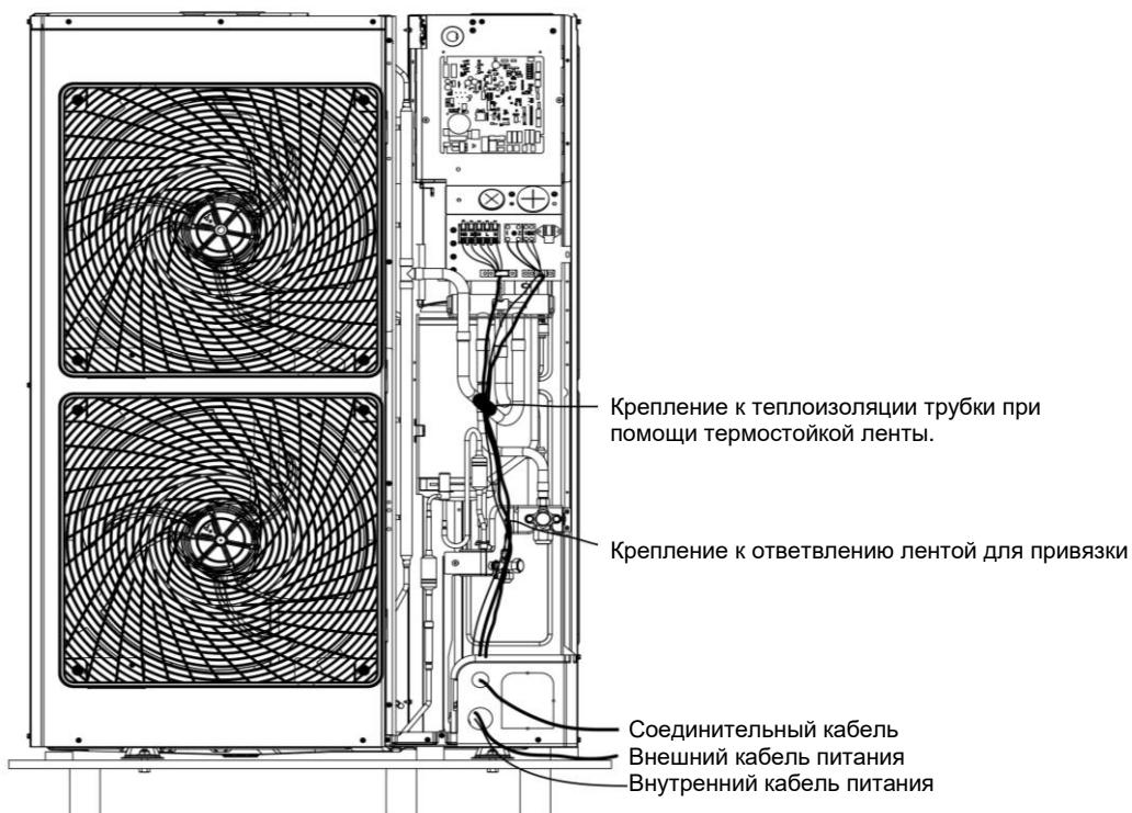
Кабель питания должен проходить вдоль правой боковины и должен быть прикреплен держателем таким образом, чтобы он не соприкасался с трубопроводом. Соединительный кабель между внутренним и наружным блоками должен также проходить вдоль правой боковины, но вне зоны прохождения кабеля питания.
