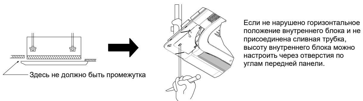
7. После установки передней панели проверьте, нет ли какого-либо промежутка между блоком и передней панелью.
