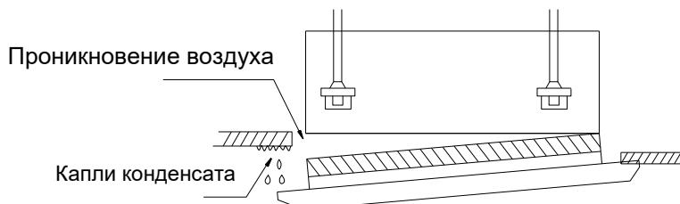
6. Если при затянутых болтах между потолком и декоративной передней панелью остается промежуток, снова отрегулируйте высоту блока (см. рисунок ниже).
