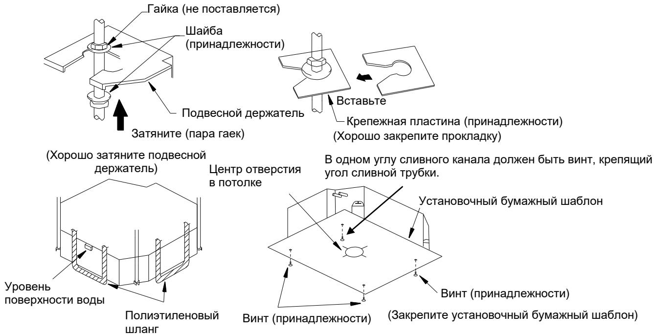
1. Закрепите подвесной держатель блока болтами для подвески между гайками и шайбами с верхней и нижней сторон держателя. Во избежание выскальзывания прокладки воспользуйтесь крепежной пластиной.
