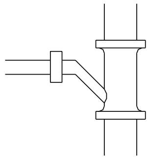
Присоединение сливной трубы под углом
