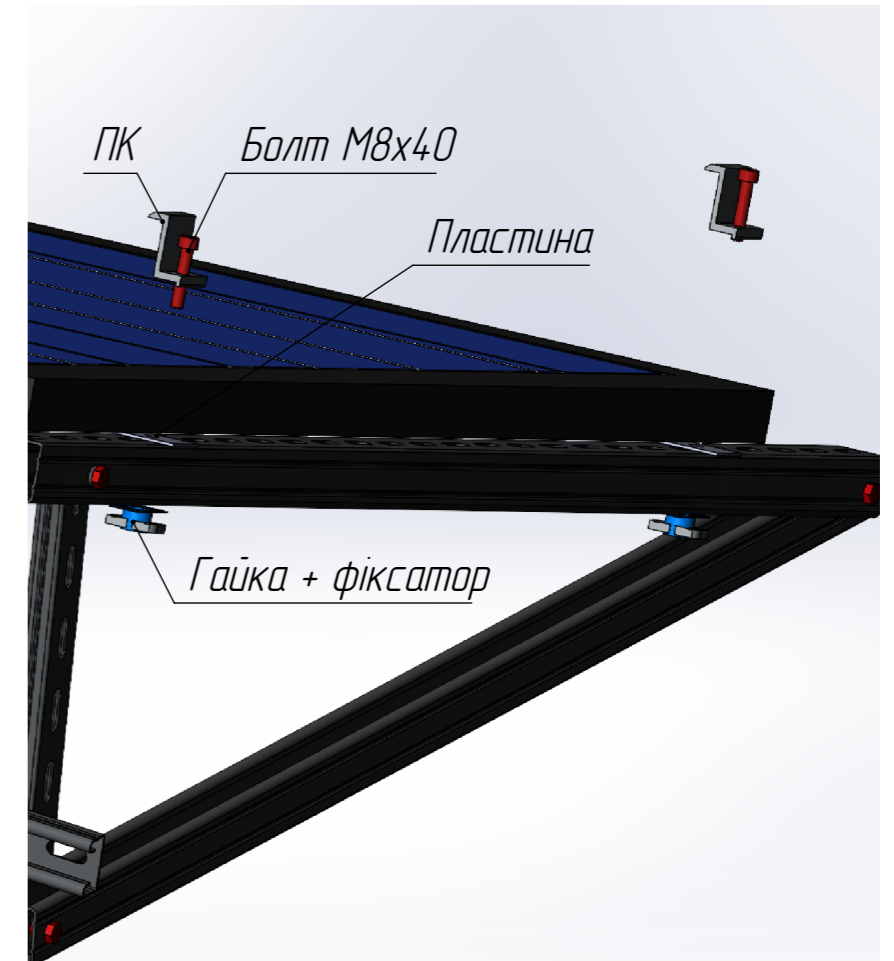
Схема закріплення прижимів к сонячній панелі
