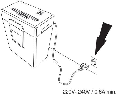
**DE** Freier Zugang zum Netzanschluß.
