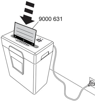
**DE** Bei nachlassender Schneidleistung oder nach jedem gefüllten Papierauffangbehälter Schneidwerk ölen (siehe Bild)! Ölpapier (Best. Nr. 9000 631) oder Spezialöl (Best. Nr. 9000 611) verwenden!
