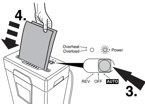
**DE** Automatischer Stopp bei zu viel Papier, Maschine blockiert, gelbe LED Overload leuchtet. Schalter auf "REV" schieben (1.), Maschine läuft rückwärts, Papier entnehmen (2.). Schalter wieder auf "AUTO" schieben (3.), weniger Papier zuführen (4.). Maximale Blattzahl:
