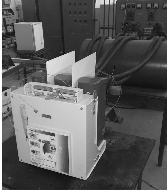
Рисунок 10.3 – Вимикач при випробуваннях на перевищення температури
