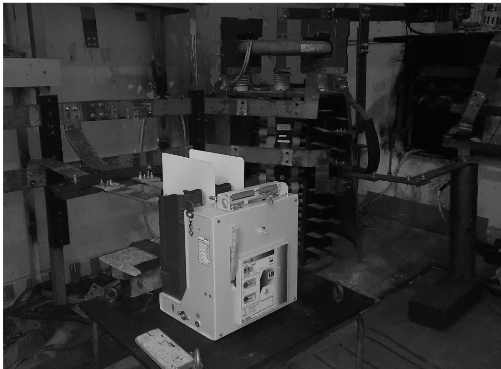
Рисунок 10.4 – Вимикач на стенді електродинамічних випробувань
