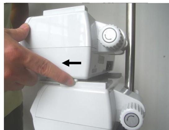
【Figure 65】 Disassembly of syringe pump
