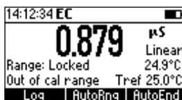
O modo de seleção automática de faixa também é desativado ao selecionar **faixa fixa** no menu de Configurações. No modo de faixa fixa, o instrumento exibirá as leituras com a resolução fixa. Até 6 dígitos podem ser exibidos. O valor máximo da **faixa fixa** é exibido piscando quando a leitura excede esse valor. Para desativar o modo de **faixa fixa** entre no menu de Configurações e selecione o modo de seleção automática de faixa.
