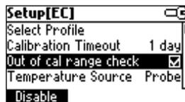
Pressione a tecla funcional correspondente para ativar/desativar esta função. Se ativado, uma mensagem de aviso é exibida quando a leitura de EC estiver muito distante dos pontos de calibração.
