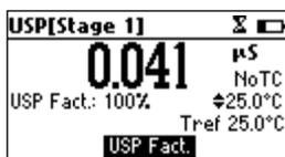
Se a fonte de temperatura for entrada manual, pressione **USP Fact.** para selecionar o fator USP a ser alterado (**↕** é exibido antes do valor 100%). Para aumentar a precisão da análise, diminua o valor do fator USP.
