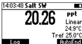
A relação derivada da escala, relaciona salinidade, condutividade, temperatura e pressão e usa uma solução com uma salinidade 35‰ como ponto de referência. Isto considerando como tendo uma condutividade de 42.914 mS/cm de 15 °C à pressão atmosférica padrão.
