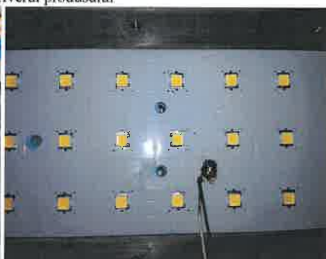
Amplasarea termocuplului pe Sbs. Modul LED
