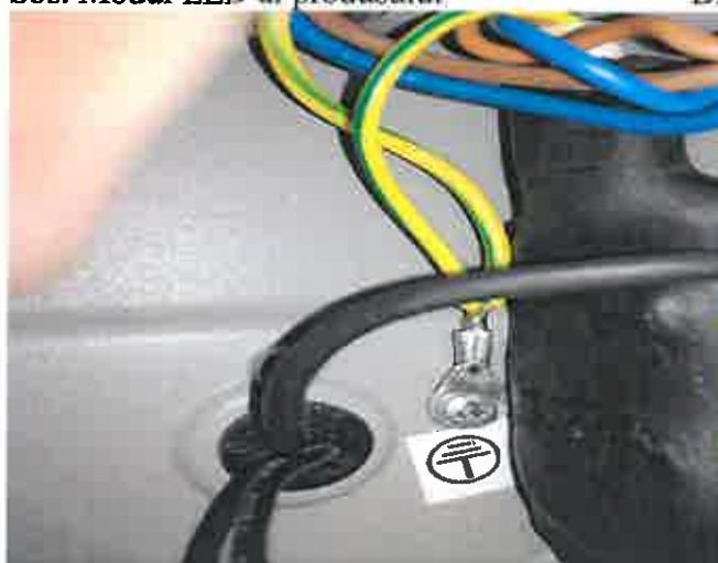
Amplasarea papucului de impamantare pe produs
