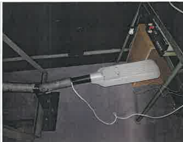
Amplasarea produsului la "Masurarea Incalzirii"
