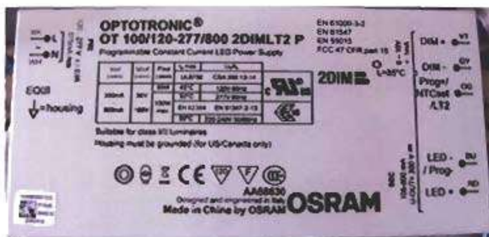
Zdroj s předřadníkem - Source and LED controller
