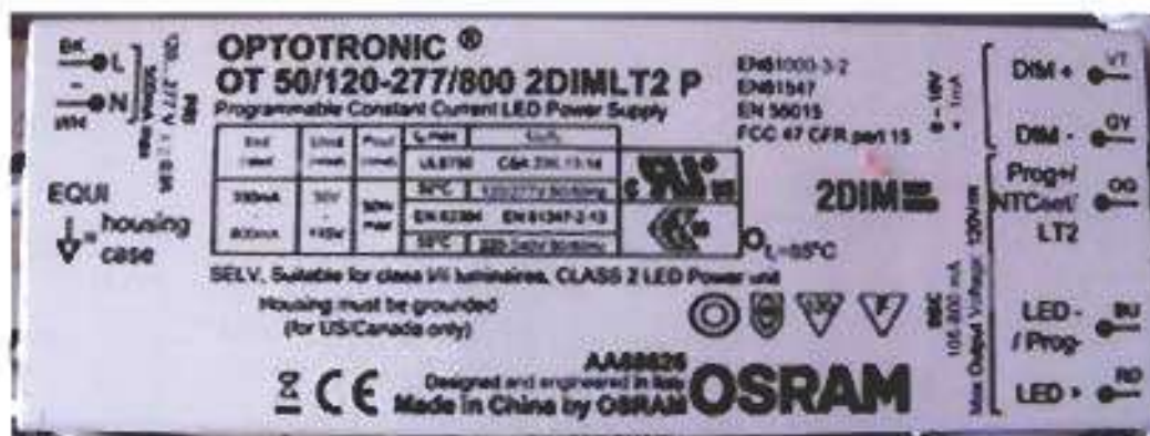
Zdroj s předřadníkem - Source and LED controller
