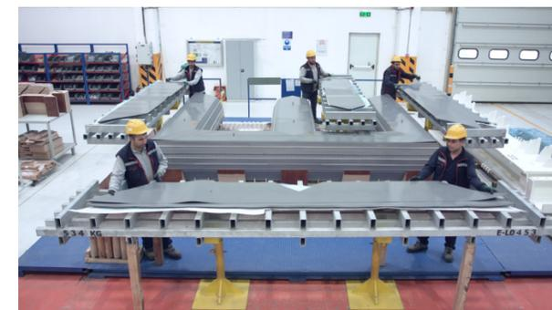
*Магнитопроводы трансформаторов изготовлены из силикатных листов с ориентированными холоднокатанными сердечниками. Сердечники изготавливаются с использованием низкопотенциальных первоклассных листов толщиной 0,23 мм и 0,27 мм в соответствии с М3 и качество М4.*
