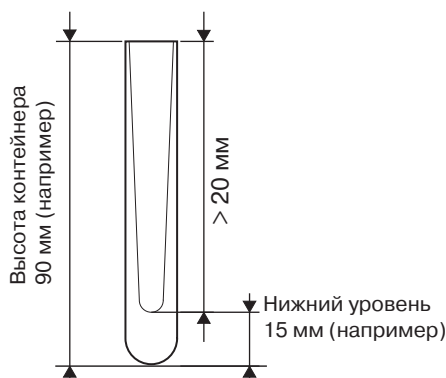
Рис. В-122 Размеры пробирки с двойным дном
