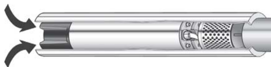
Ilustración 6-1: Camisa de refrigeración
