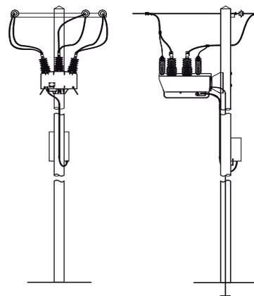
СХЕМА УСТАНОВКИ НА СТОЛБЕ ТРЕХФАЗНОГО
