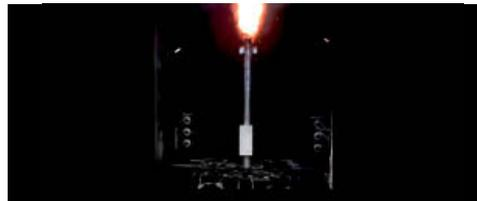
ИСПЫТАНИЕ НА УДЕРЖАНИЕ ДУГИ ВНУТРИ РЕКЛОУЗЕРА
