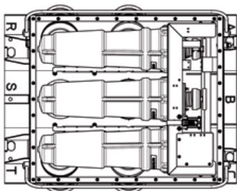
Состояние реклоузера также отображается микровыключателями, соединенными с электроникой в шкафу управления. Электронная плата, установленная в корпусе выключателя, не содержит активных компонентов, что радикально повышает надежность.
