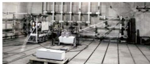
УДЕРЖАНИЕ ДУГОВОГО РАЗРЯДА, КОНСТРУКЦИЯ С ОТВОДОМ ГАЗОВ ДУГОВОГО РАЗРЯДА
