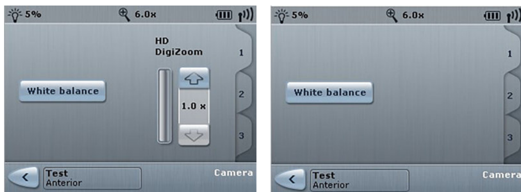
Fig. 92: Stânga: corecție balanță de alb HD / dreapta: corecție balanță de alb microscop de operație digital
