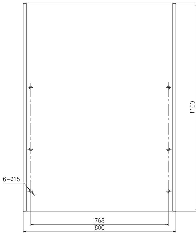
Рис. 9 Габаритный чертеж фундамента ячейки М 12кВ
