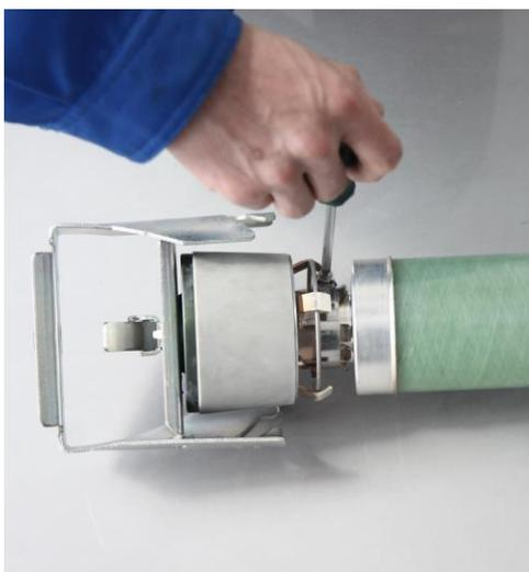
3.5.7 Вставьте торцевую крышку с предохранителем в изоляционный цилиндр и поверните ручку управления по часовой стрелке, чтобы закрыть и герметизировать изоляционный цилиндр предохранителя.
