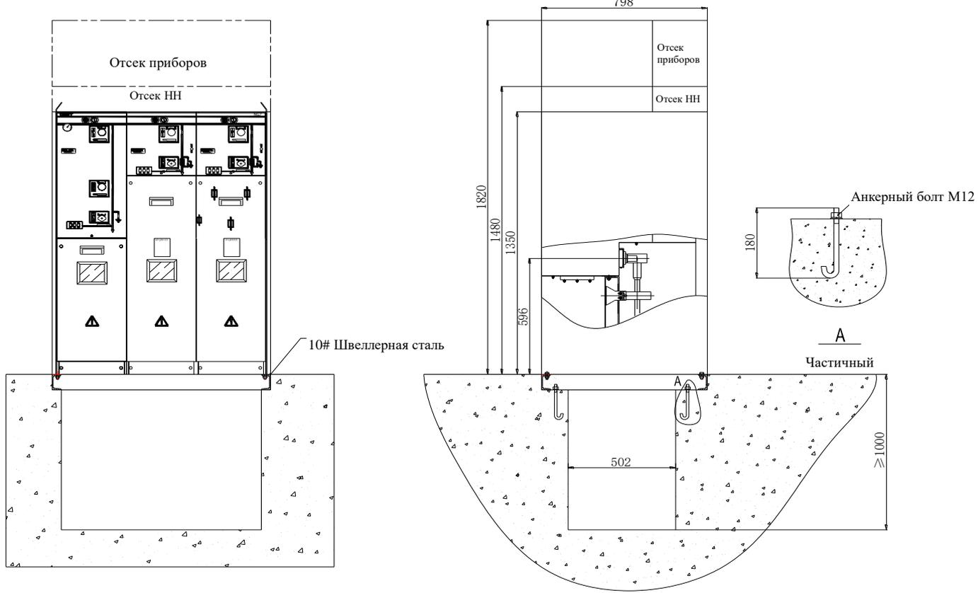
Рис.3 Чертеж установки фундамента
