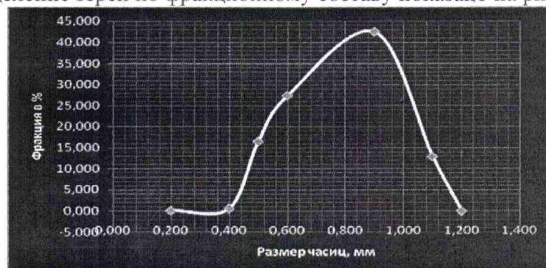
Рис. Кривая распределения зёрен по фракционному составу (гауссова кривая).
