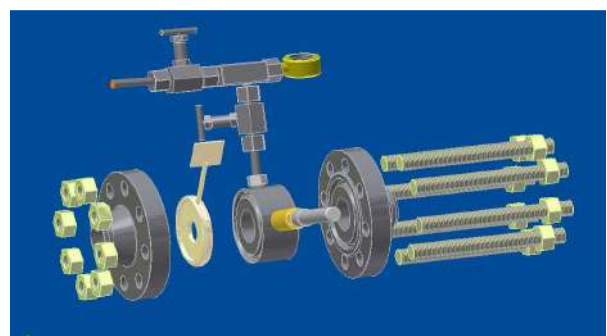
Sondă debitmetrică ( tub Pitot dublu )
