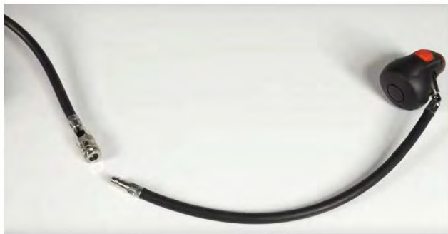
Fig. 9. Conexiunea de tip rapidă, cu autoîmchidere, între conducta de presiune medie și aparatul pulmonar (cuplă mamă la conducta de presiune medie și cuplă tată la conducta de la aparatul pulmonar).
