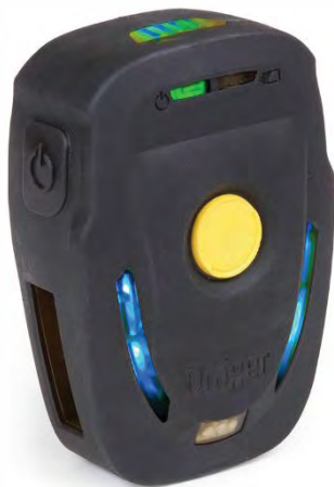
Fig. 6. Aparatul personal de siguranță și alarmă (PASS) Draeger Bodyguard 1000: a) față, b) spate (cu fixator tip clipsă-crocodil).
