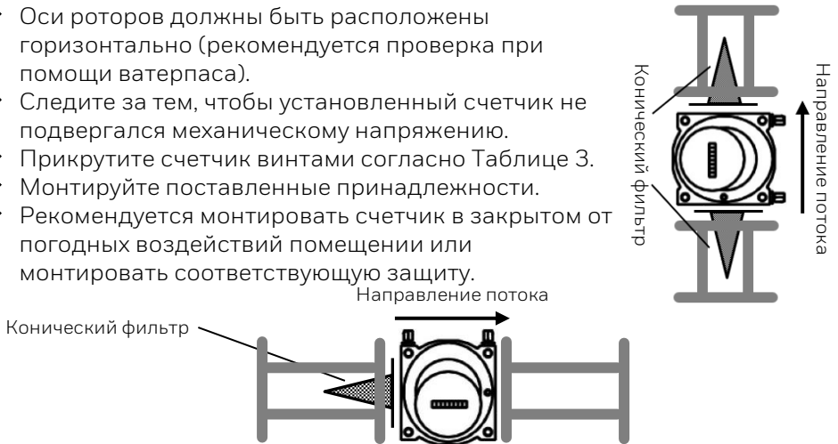
Рис. 11 | Установка конического фильтра
