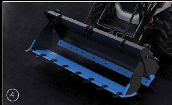
4 Более долговечный ковш переднего погрузчика, усиленный сталью hardox
