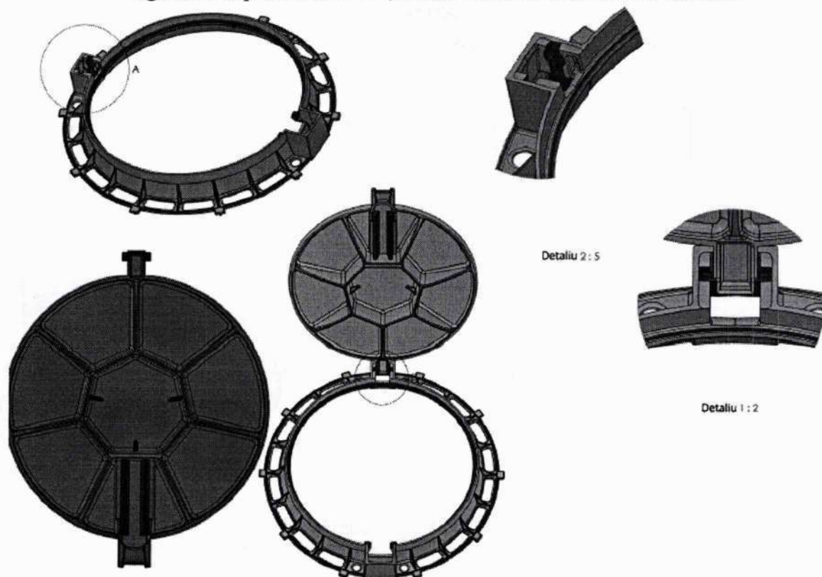
Figura 3. Capac fontă D400, rotund. Detalii
