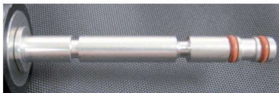
Inelul „O” trebuie montat așa cum se arată
