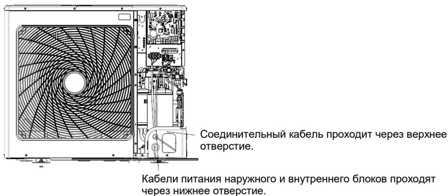
b) Подключение однофазных блоков при совместном питании:
