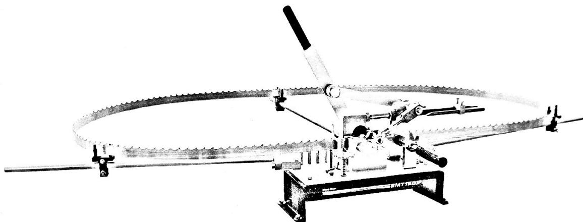
Ceapräziți ușor pânze pe ambele fețe simultan cu ajutorul mașinii manuale de ceaprazuit BMT150, care vă va ajuta să prelungiți perioada în care pânza rămâne ascuțită, să-i îmbunătățeji performanța la tăiere și să obțineți o tăiere a lemnului de cea mai mare acuratețe.
