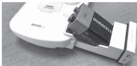
Рисунок 9: Установка новой батареи
