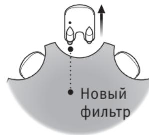
Выньте инструмент из корпуса. Инструмент имеет два кончика: один для снятия старого фильтра и другой с надетым новым серным фильтром.
