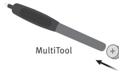
MultiTool можно использовать для замены элементов питания. Используйте магнитный конец для извлечения и вставки батареек.
