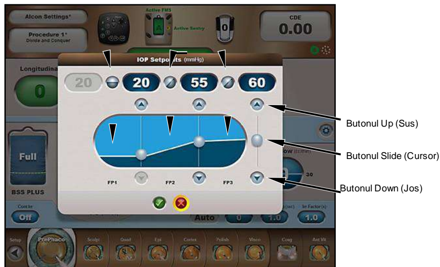
Figura 2-78 Valori de referință pentru PIO (Liniare) pentru tehnologia Active Fluidics™ Această casetă de dialog cu valorile de referință pentru PIO este un exemplu al modului în care setările pentru pedală au fost modificate în mod liniar sau fix în cele trei intervale ale pedalei. Noile setări sunt acceptate prin apăsarea butonului verde de confirmare (✓).
