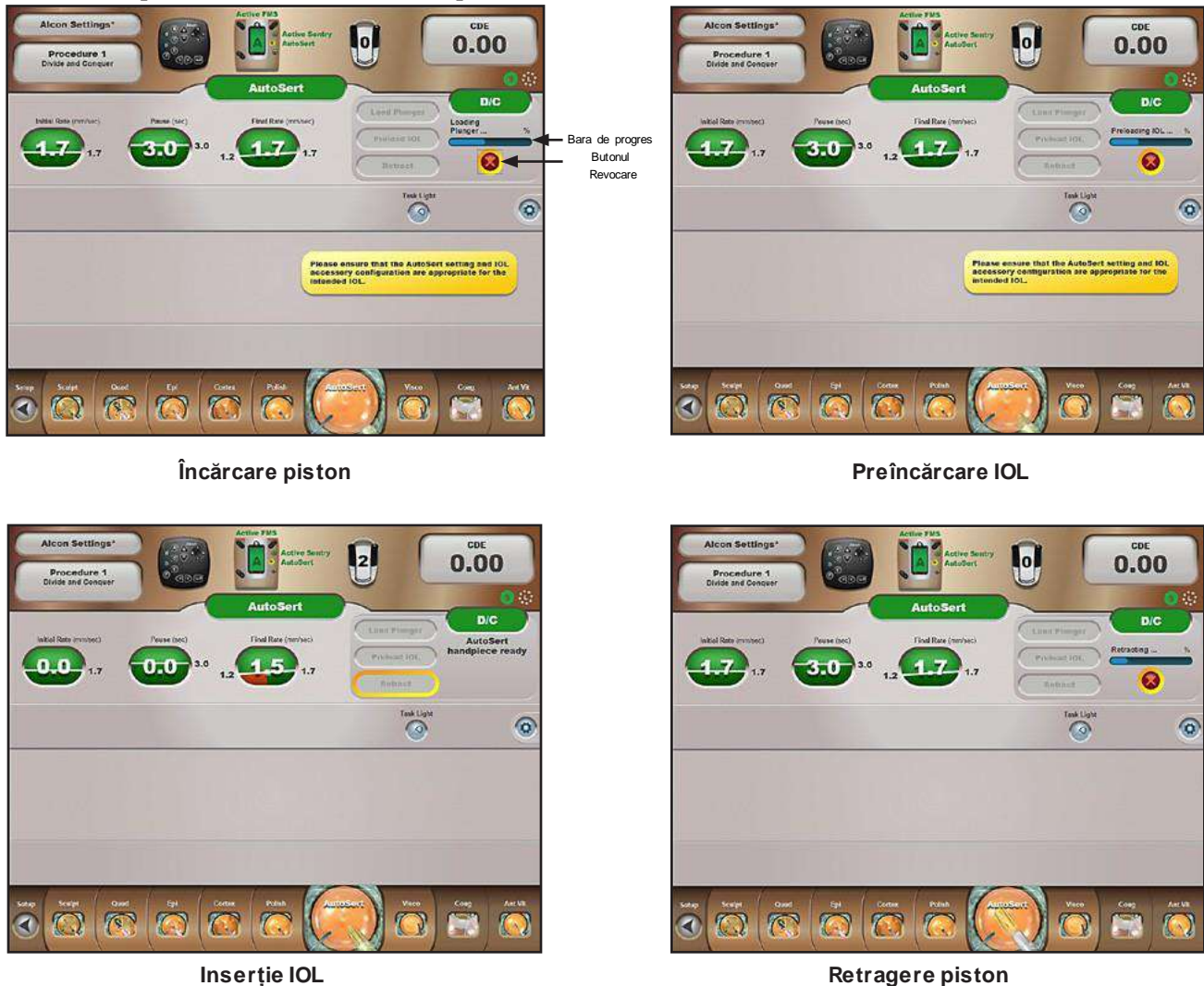
Figura 2-91 Injecteur IOL Intrepid™ AutoSert™ Trebuie să urmați o procedură scurtă înainte de a utiliza funcția injectorului AutoSert™ . În imaginea din stânga sus, pistonul este încărcat prin apăsarea butonului Load Plunger (Încărcare piston) . În imaginea din dreapta sus, este apăsat butonul Preload IOL (Preîncărcare IOL) după amplasarea cristalinului în poziția corectă pe vârful pistonului. În imaginea din stânga-josse introduce cristalinul după apăsarea pedalei în poziția 2. După inserție, pedala este eliberată și butonul Retract (Retragere) este apăsat pentru a retrace pistonul înapoi în injectorul IOL.
