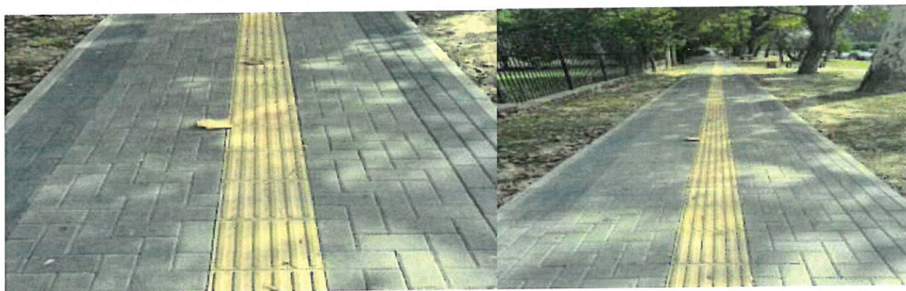
Fig. 1.12 Model de amenajare a pavajului tip caramida plus pavaj tactil.
