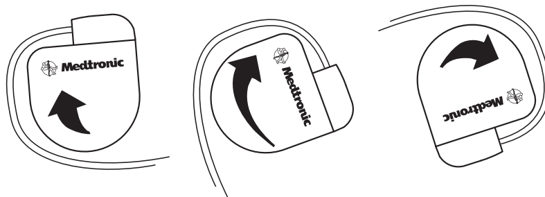
Figura 4. Rotirea dispozitivului pentru înfășurarea derivației
