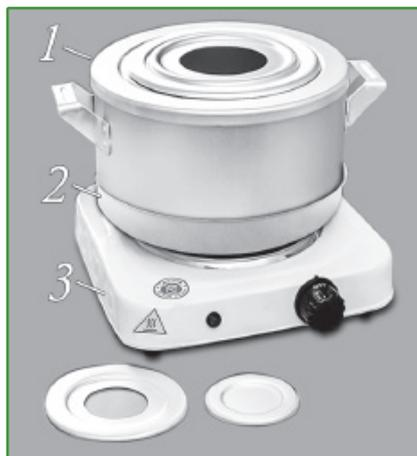
2. Баня песочная (можно приобрести отдельно) - предназначена для подогрева различных сосудов посредством горячего песка. Изготовлена из алюминия. Состоит из тарелки. Габаритные размеры, мм - (206±5,0)×(40±5,0). Объем, л - 1,3. Вместимость песка, около 1 кг (арт. 25002220).
