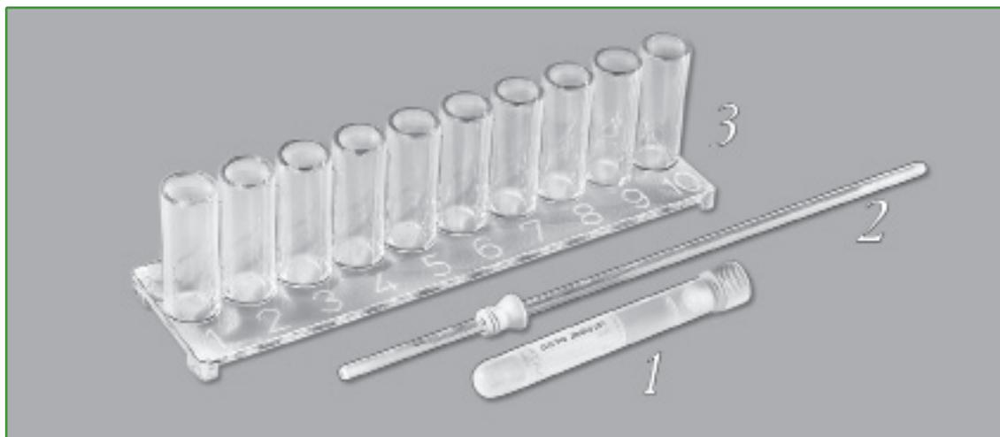
1. Цилиндрическая пробирка с розовой пробкой изготовлена из полипропилена. Содержит 0,2 мл цитрата натрия (3,8%), линия наполнения кровью - 1 мл, соотношение антикоагулянт/кровь - 1:4. Общий объем пробирки, мл - 5; наружный диаметр, мм - 12; высота без пробки, мм - 86.
