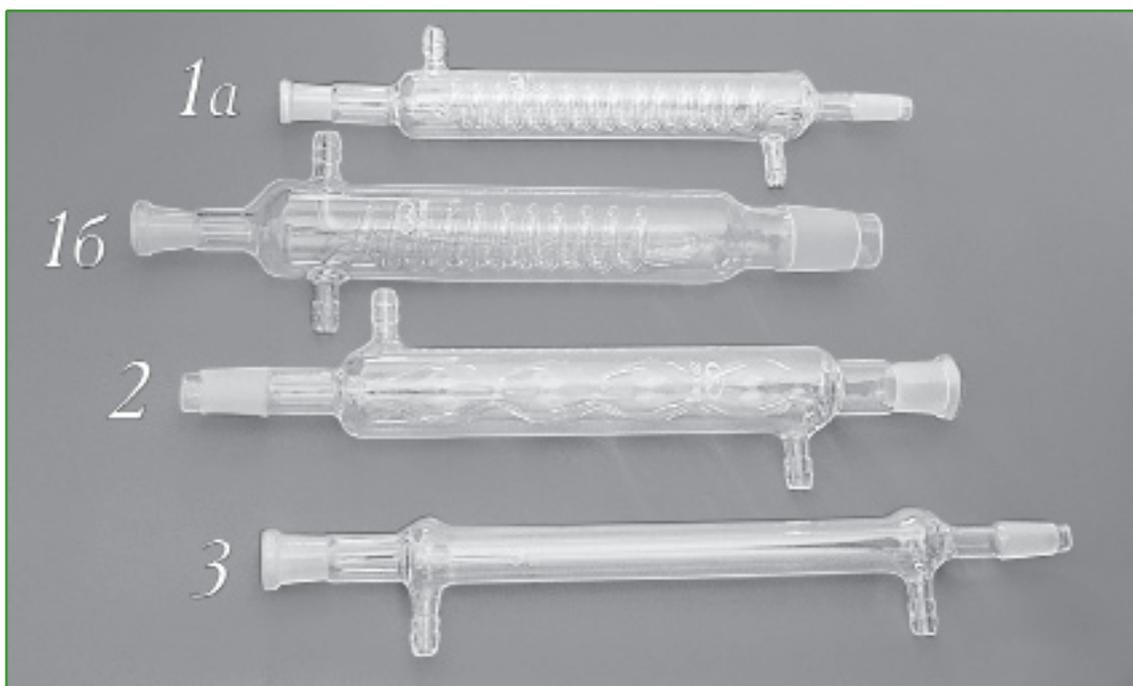
Предназначены для охлаждения и конденсации паров жидкостей при перегонке. Изготовлены из химико-лабораторного стекла по ГОСТ 21400-75.
