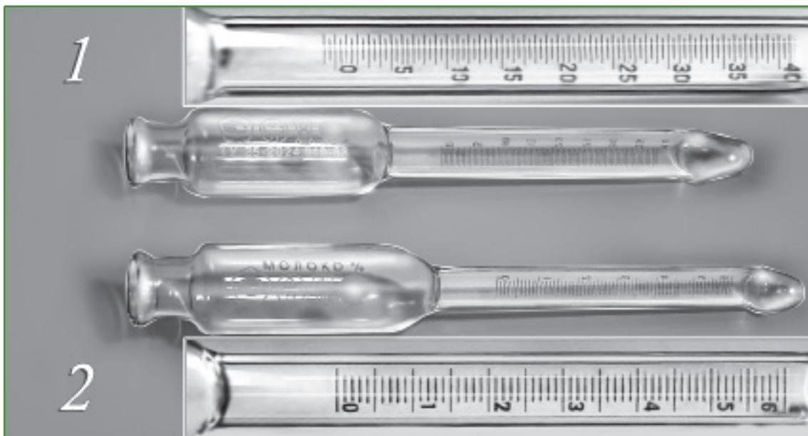
Принцип измерения основан на денатурации белковых веществ кислотами и изоамиловым спиртом с последующим отделением жиров центрифугированием. Шкала коричневого цвета.
