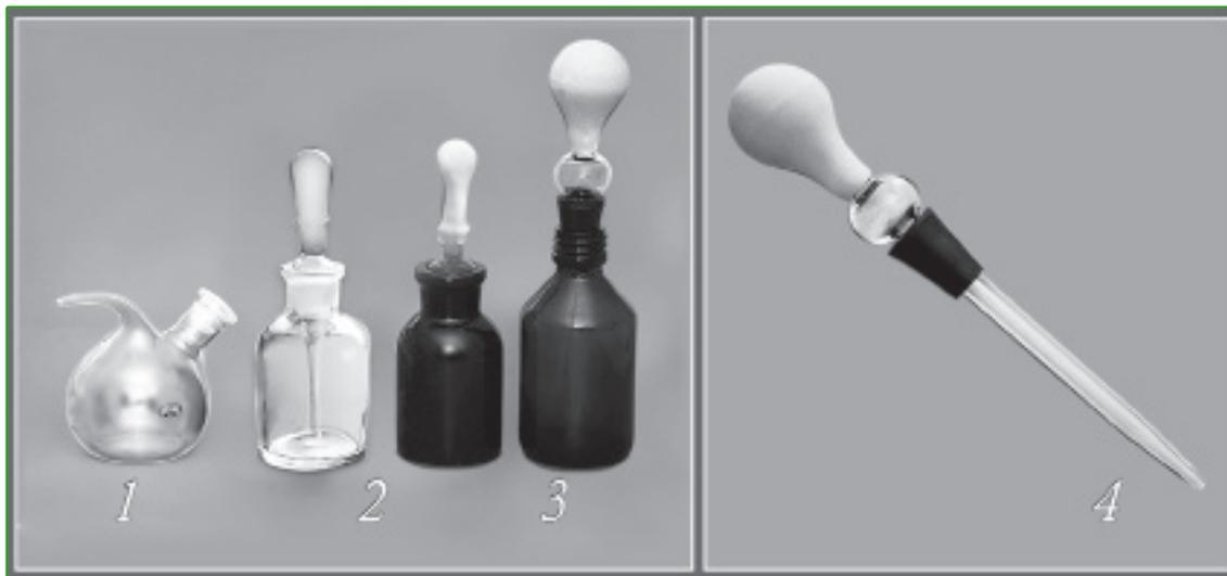
Предназначены для капельного дозирования различных растворов в лабораторной практике. Изготовлены из химико-лабораторного стекла по ГОСТ 21400-75, медицинского стекла по ГОСТ 19808-86.
