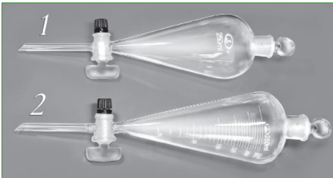
Предназначены для разделения несмешивающихся жидкостей в процедурах экстрагирования. Изготовлены из химико-лабораторного стекла по ГОСТ 21400-75, медицинского стекла по ГОСТ 19808-86.
