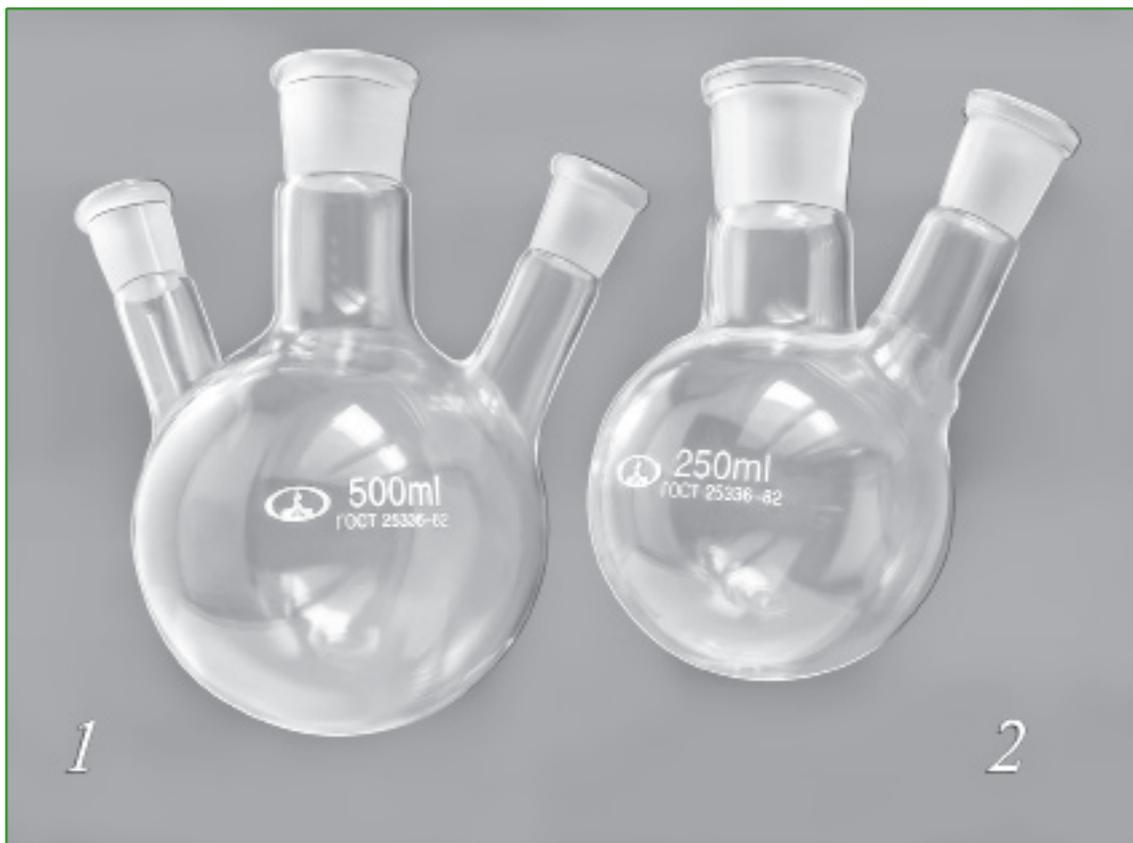
Разработаны для выпаривания, синтеза и других работ в лабораторных условиях. Изготовлены из стекла ТС по ГОСТ 21400-75. Пробки приобретаются дополнительно (стр. 31, 120-122).
