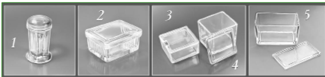
Предназначены для окрашивания микропрепаратов на предметных стеклах. Индивидуальная упаковка. Изготовлены из химико-лабораторного стекла\*.
