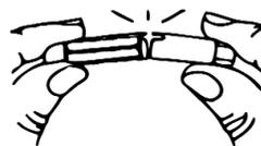
Για να ανοίξετε τη μονάδα αεραγωγού/ανακαλλιέργειας, σπάστε τη σφράγιση με περιστροφική κίνηση.
