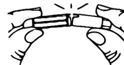
Pour ouvrir l'unité de ventilation/repiquage, casser la bague d'un mouvement de torsion.
