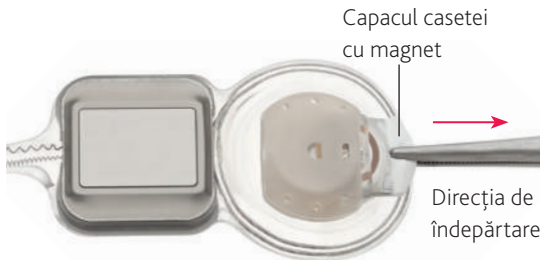
Figura 24: Implantul CI622 cu caseta cu magnet parțial îndepărtată
