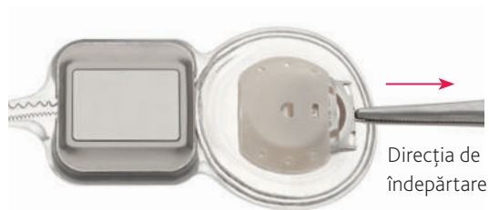
Figura 26: Îndepărtarea casei cu magnet al implantului CI622 utilizând ochetul metalic
