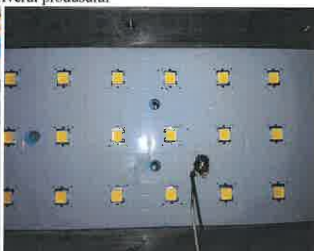
Amplasarea termocuplului pe Sbs. Modul LED
