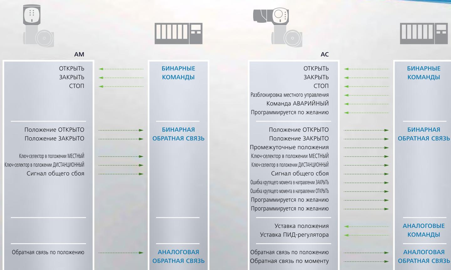
Соединение по полевой шине применяется, в первую очередь, по причине более низкой стоимости. Кроме того, в системы автоматизации полевых устройств, в том числе приводов, успешно внедряются интерфейсы последовательной связи. Удаленная настройка параметров, система управления оборудованием и другие повышающие эффективность функции без полевой шины были бы невозможны. Приводы компании AUMA с интерфейсами полевой шины являются примером оборудования, разработанного по последнему слову техники.
