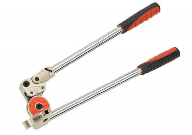
Инструментальные ручные рычажные трубогибы RIDGID серии 600 для больших нагрузок предназначены для гибки труб из нержавеющей стали и труб из других твердых материалов, таких как сталь и титан, Ø 6 – 12 мм (3/16" – 1/2"), на угол до 180°. Производитель: RIDGID (РИДЖИД) – США.
