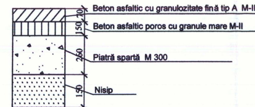
Restabilirea îmbrăcămintei din asfalt a drumului
