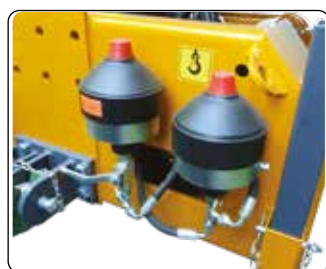
Accumulatori di azoto. Lift float nitrogen accumulator.
