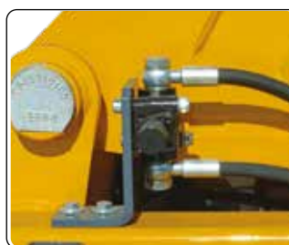
Doppio effetto. Single acting - double acting automatic switch.
